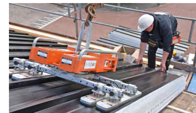
Kompakt 4 Flex - med justerbare, specielt formede sugekopper for montering af en bred vifte af profilerede paneler.
